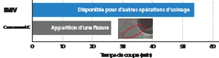
Conditions de coupe :  $V_c = 120$  m/min,  $a_p \times a_e = 5 \times 7,5$  mm,  $f_z = 0,25$  mm/t,  $\phi 20$  (1 plaquette), à sec, pièce : 42CrMo4
