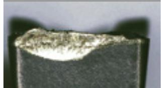
Au bout de 15 minutes d'usinage.
